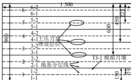
图10 土体分层填筑图(单位: mm)
